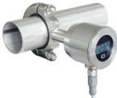
Der GTL737-3, mit drehbarem Feldgehäuse und integriertem Messumformer mit hintergrundbeleuchteter Vor-Ort-Anzeige (LCD), montiert auf einem DN 50-Rohr
